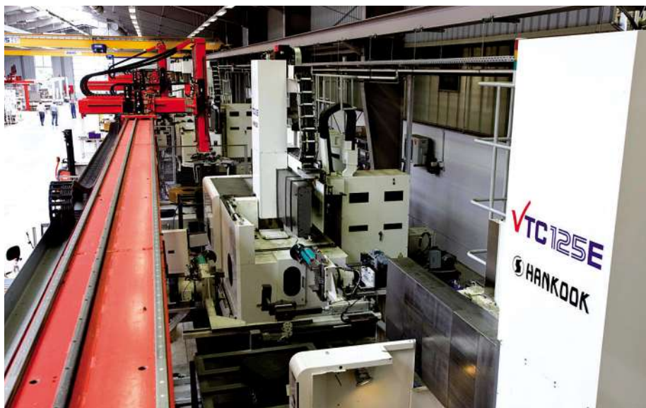
Bild 2: In der Fertigungslinie übernimmt ein Portal mit Robotern die Be- und Entladung der Bearbeitungszentren.
