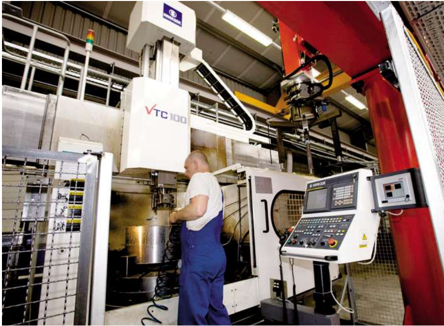
Bild 3: Überprüfung der Schneidwerkzeuge an einer Karusselldrehmaschine Hankook VTC100.
