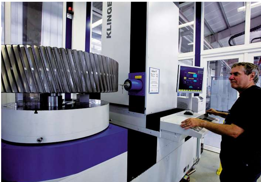
Bild 4: In einem vollklimatisierten Messraum werden die Zahnräder kontrolliert.
