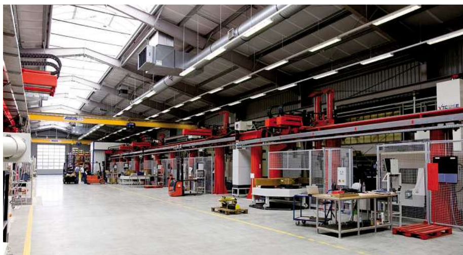
Bild 1: Klimatisierte Fertigungslinie mit zehn kompakten Hankook-Bearbeitungszentren für die Hartbearbeitung von Zahnrädern für Großgetriebe von Windkraftanlagen.
