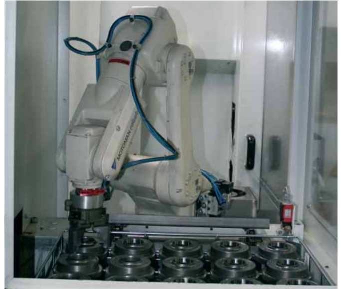
Roboter an den Maschinen übernehmen vielfältige hauptzeitparallele Handhabungsaufgaben
