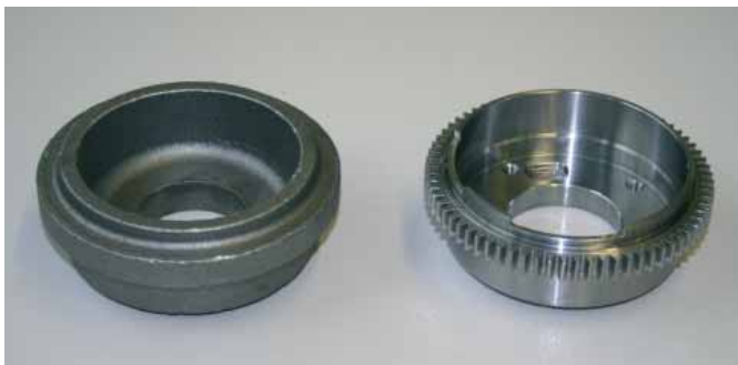
Aus einem Schmiederohling entsteht in einem mehrstufigen Bearbeitungsprozess das fertige Zahnrad
