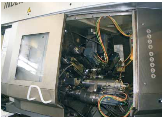
Die MS52 Compact von INDEX besticht durch eine kompakte Spindeltrummel und ihre hervorragende Zugänglichkeit des Arbeitsraumes
